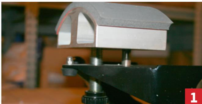
1,2. Для смены насадки поднимите нагревательный элемент.
