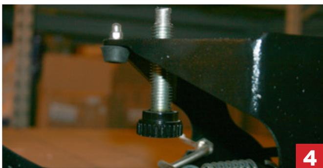
4. В отличие от подобных термопрессов, регулировка силы прижима осуществляется нижней насадкой. Т.е. верхняя нагревательная плита остается на месте, а нижнюю насадку можно опустить или поднять с помощью регулировочного винта. Тем самым уменьшить или увеличить силу прижима.
